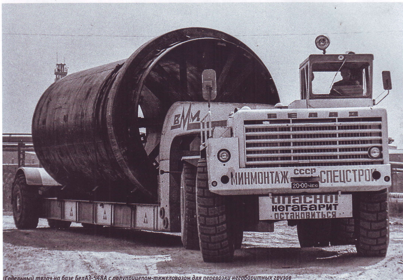
Седельный тягач на базе БелАЗ-548А с полуприцепом-тяжеловозом для перевозки негабаритных грузов
