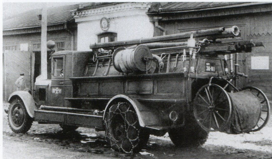
Пожарный автонасос ПМЗ-1. Для улучшения проходимости машины на задние колеса надеты цепи противоскольжения
