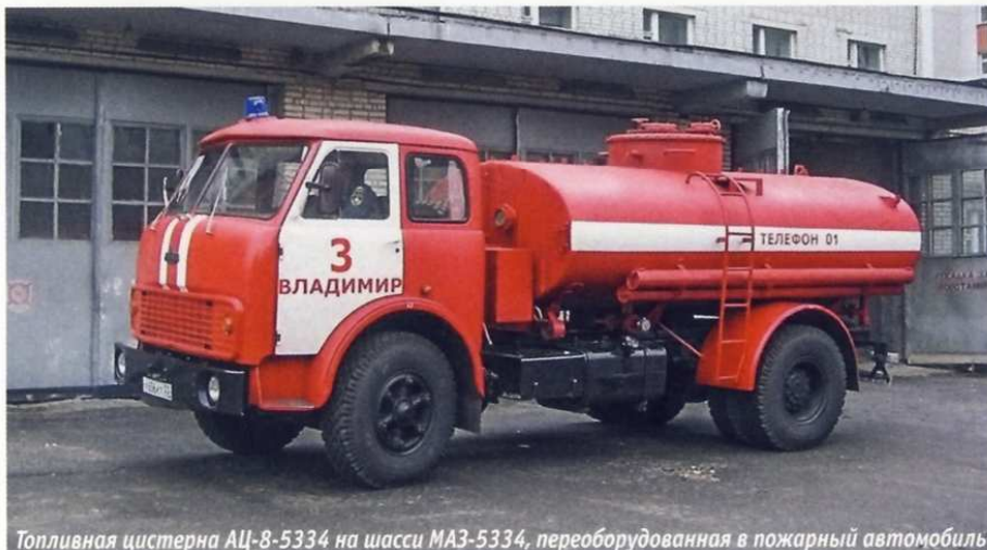
Топливная цистерна АЦ-8-5334 на шасси МАЗ-5334, переоборудованная в пожарный автомобиль
