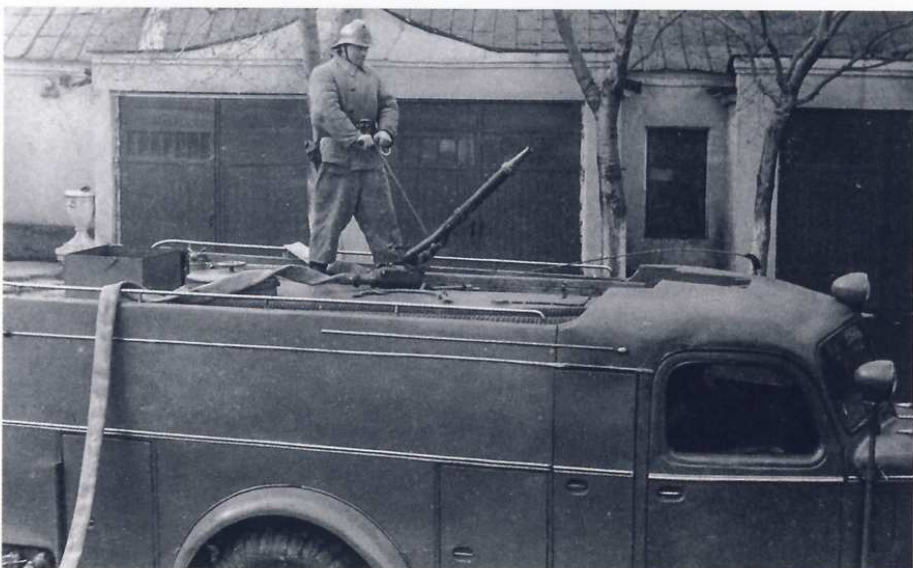
Серийная автоцистерна АЦ-45 (М205) ЦА Торжокского завода
