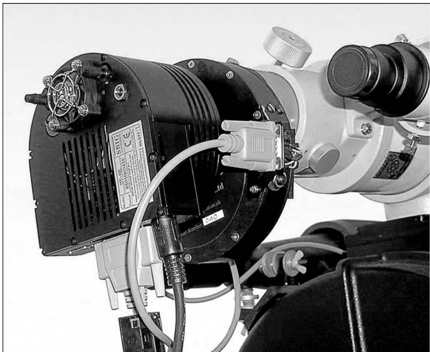
ПЗЗ-камера SBIG ST8e на окулярному вузлі телескопа
