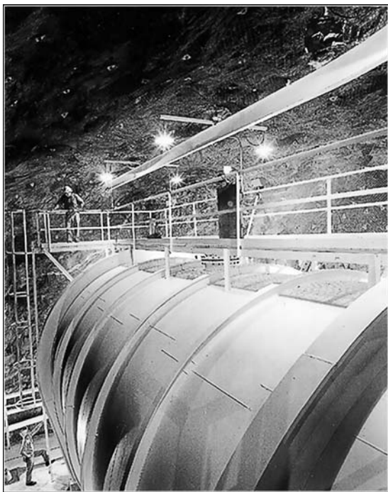
Контейнер із хлорвмісною речовиною, що знаходиться глибоко під землею у шахті — частина експерименту з пошуку сонячних нейтрино у Південній Дакоті, США
