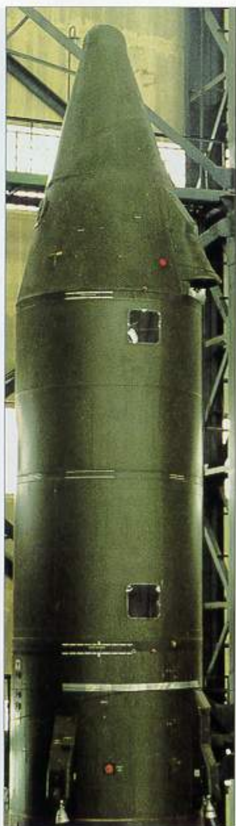
Вторая ступень ракеты Р-36 Second stage of R-36 missile
