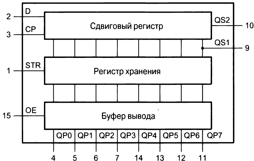
Рис. 15.4. Упрощенная схема микросхемы 74НС4094
