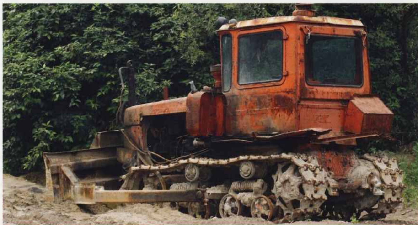
На тракторе ДТ-75 установлен двигатель СМД-14, с насосом высокого давления типа Л4ТН-8,5 × 10Т или ЛСТН-48510 и всережимным регулятором РЛ-850. Распыление топлива начинается при давлении 125±5 кг/см 2 .
