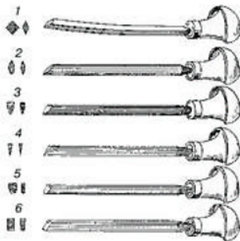
Рис. 228. Образцы форм стихелей для торцовой гравюры: сверху вниз: 1, 2 — грабьстихели; 3, 4 — тоньстихели; 5, 6 — болтстихели
