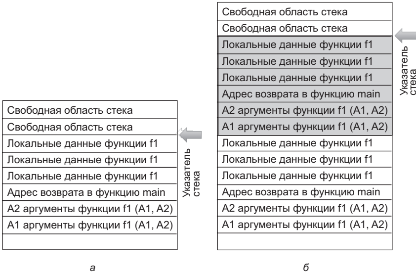
Рис. 30.1. а — структура стека до вызова функции f_2 из функции f_1 ; б — структура стека после вызова функции f_2 из функции f_1
