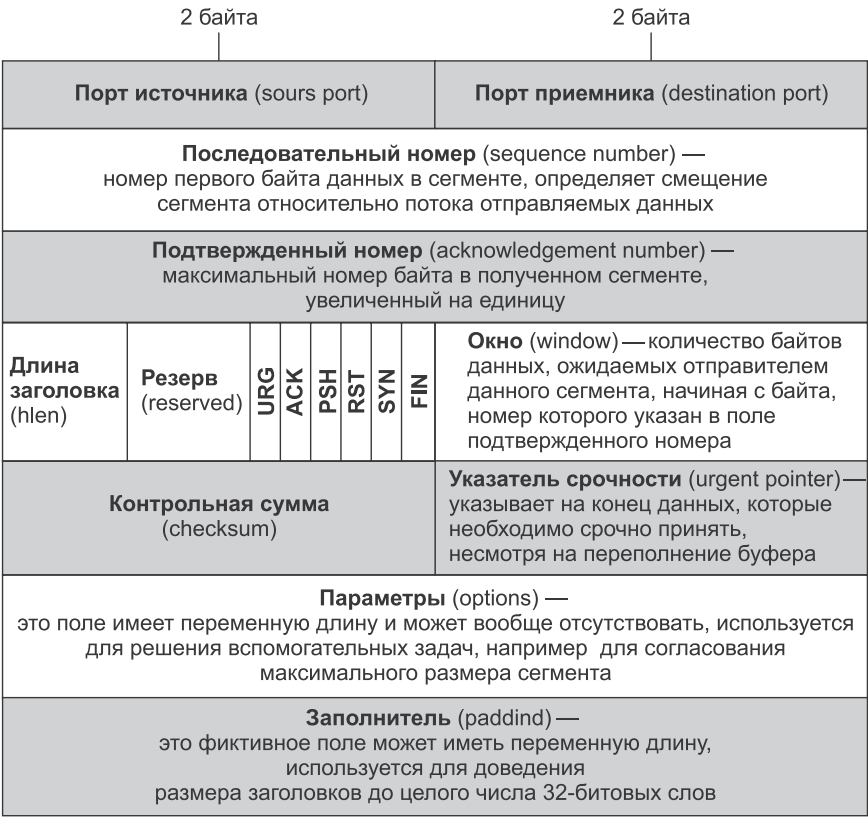
Рис. 15.5. Формат заголовка TCP-сегмента
