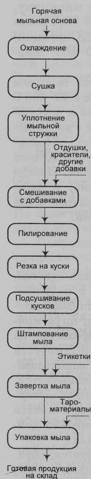
Рис. 11 Принципиальная схема обработки твёрдого туалетного мыла
