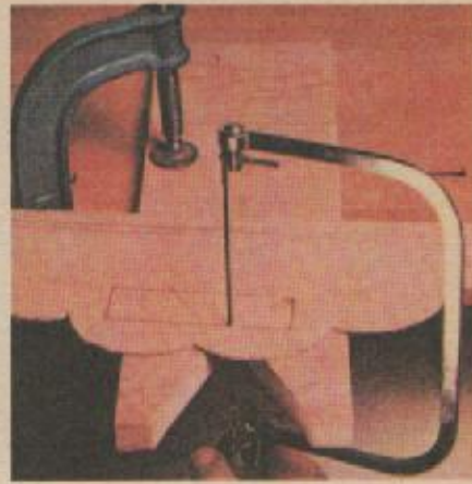
8. Выпилите отверстие для руки. Обратите внимание на простой станок, закрепленный струбциной на столе или на верстаке.
