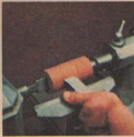
6. Скруглив заготовку, обработайте ее скребком. Инструмент должен быть острым.
