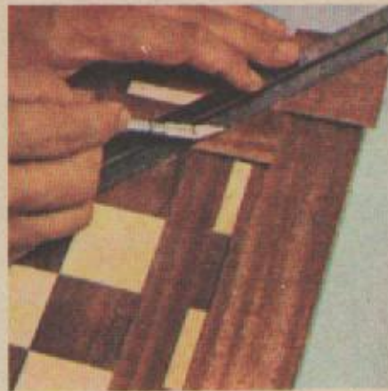
7. Склейте гуммированной лентой полосы для окантовки. Уложите их внахлестку на углах доски и прорежьте под углом 45^\circ .
