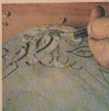
6. Форму листьев определите сами. Обратите внимание на канавки, которые прорезаются угловой стамеской или уголком.
