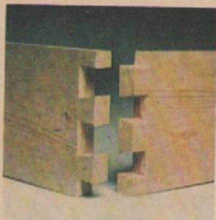
5. Соединения на шип «ласточкин хвост» очень прочны. Сначала запилийте шипы на доске справа и разметьте по ним проушины.
