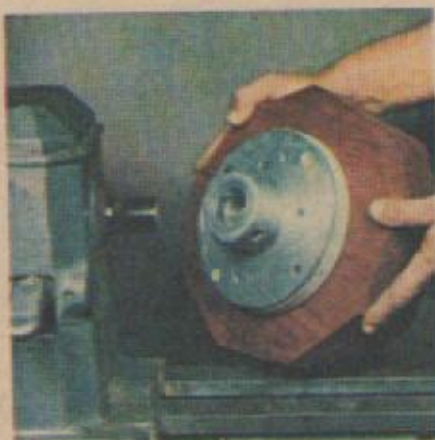
18. Шурупами закрепите на основании фанеру и прикрепите ее к планшайбе. Центр планшайбы должен совпадать с центром заготовки.
