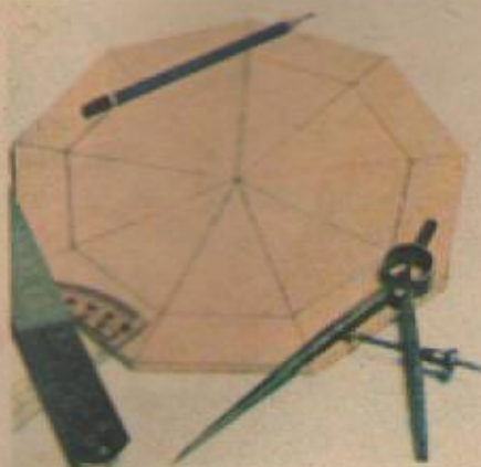
14. Сделайте шаблон для деталей вазы. Разделите круг на девять сегментов (по 40^\circ ) и нарисуйте контуры деталей.
