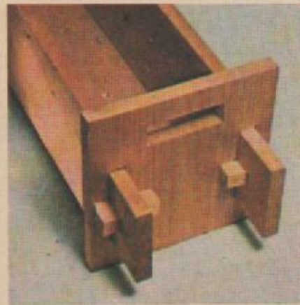
10. В дне ящика просверлите 5...6 отверстий. Чтобы соединения были плотными, вбейте клинья легкими ударами киянки.
