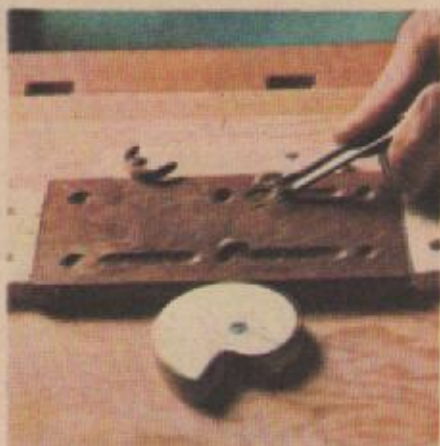
5. Обратите внимание на то, как режет стамеска в различных направлениях.
