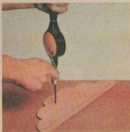
6. Выпилите ручки по контуру и просверлите отверстия для выпиливания прорезей для материала.
