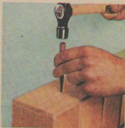
6. Утопите шляпки гвоздей при помощи бородка. Отверстия можно заполнить шпаклевкой.
