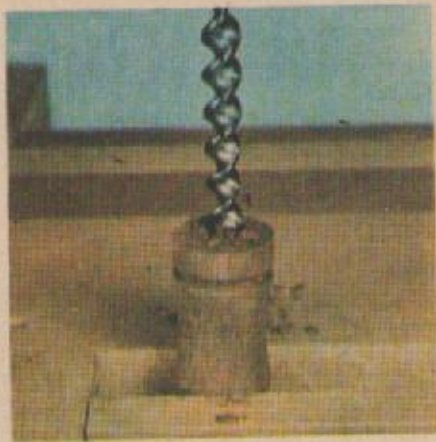
10. Отшлифовав заготовку на станке, просверлите коловоротом отверстие для свечи.
