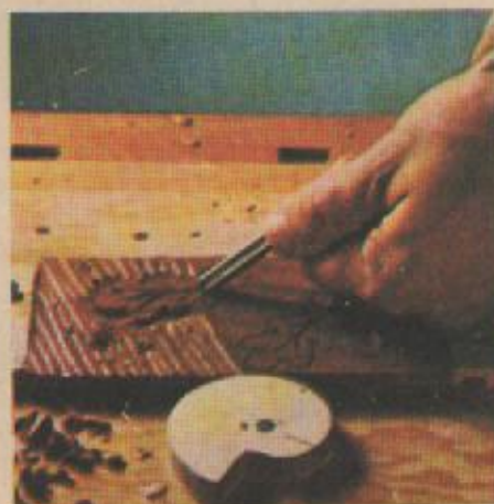
16. Рельефное изображение дубовых листьев. Обратите внимание на выемчатый фон, выполняемый полукруглой стамеской.
