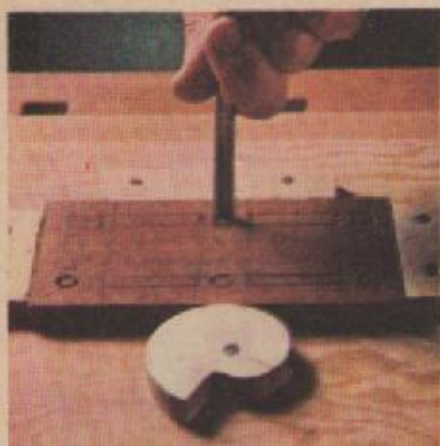
4. Для вырезания этого узора нужна стамеска небольших размеров. Поворачивая стамеску, вырежьте центральную часть кружков.
