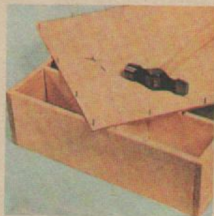
7. По размеру полки вырежьте из фанеры заднюю стенку, закрепите ее на клею и гвоздях.
