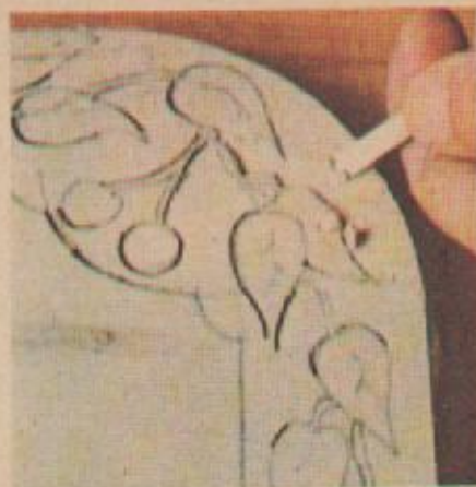
5. Удалите стамеской лишний материал фона, постарайтесь сделать листья более рельефными, вырезая дерево под их краями.
