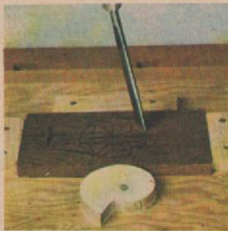
10. Нарисуйте на дощечке круг с шестью лепестками. Сделайте надрезы по окружности и на краях лепестков.
