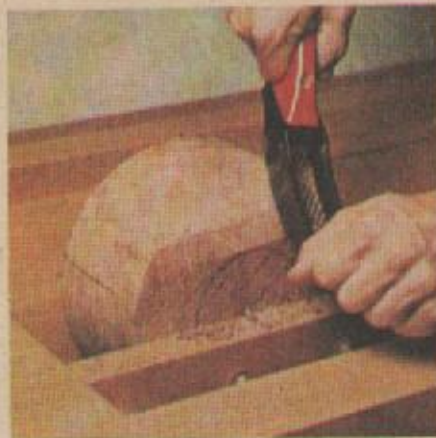
6. Снимите вазу с фанеры и обработайте рашпилем. Вместо тисков можно использовать две струбцины.
