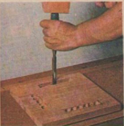
9. На торцовой стенке имеются отверстия для ручки и два гнезда для боковых стенок. Сначала высверлите отверстия, а затем долбите стамеской или долотом.
