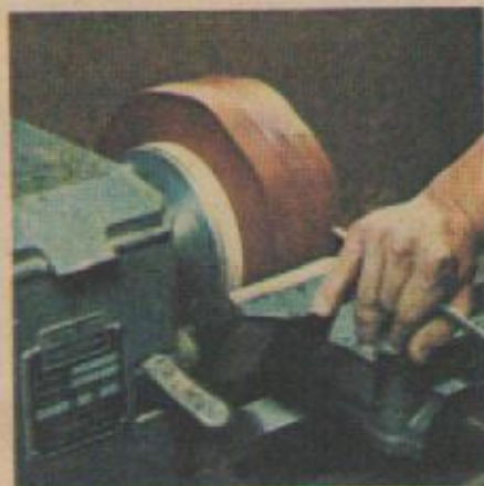
19. Обточите внешнюю поверхность острой стамеской. Следите, чтобы острый угол стамески не вгрызлся в материал.
