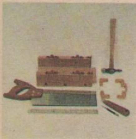
1. Стусло, обушковая ножовка, стальная линейка, молоток, зажимное приспособление, нож, бородок.
