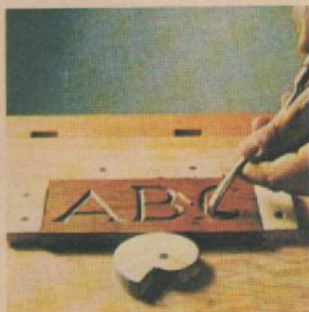
14. Вырезав контуры ножом, сделайте аккуратные срезы стамеской по направлению к центру.
