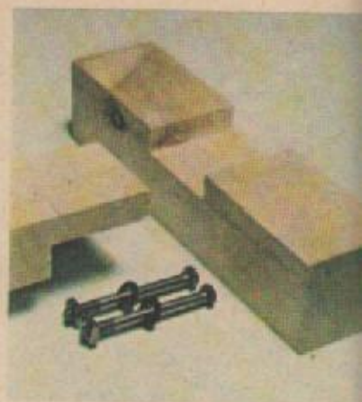
7. Соединение вполдерева (внакладку). Если бруски одинаковые, лишняя древесина удаляется на глубину, равную половине их толщины.
