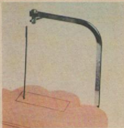
7. Освободите верхний конец полотна пилки и вставьте его в просверленное отверстие. Затем снова закрепите полотно.
