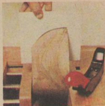
7. Проверяйте форму вазы по шаблону, который показывает, где надо удалить лишний материал.
