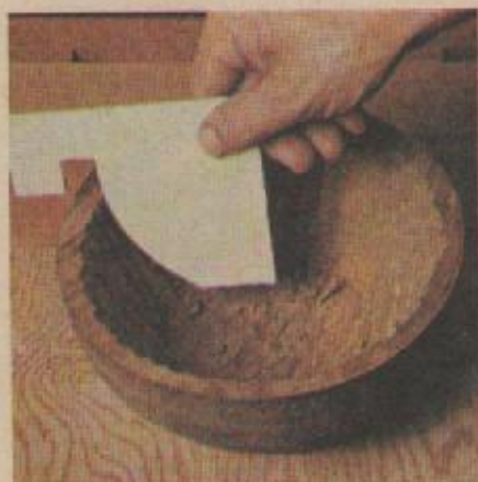
9. Чаще пользуйтесь шаблоном для проверки формы вазы. Допускаются небольшие отклонения.
