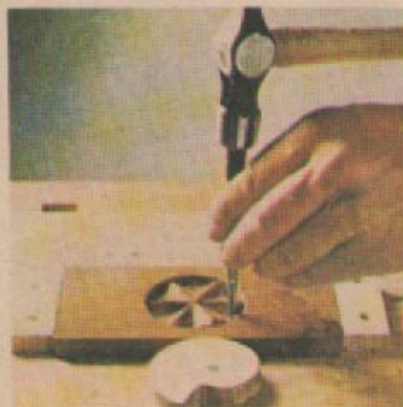
12. Воротком или шляпкой гвоздя с наконечником сделайте набивку шагрени.
