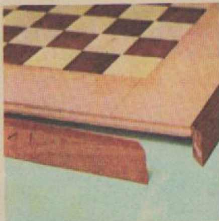
6. К кромкам фанерной доски приклейте и прибейте рейки. Соединять рейки в углах доски не обязательно, но если вы хотите сделать это, смотрите с. 38.
