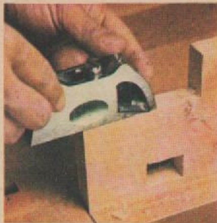
6. Рубанок с ножом в передней части удобен для строгания в труднодоступных местах.
