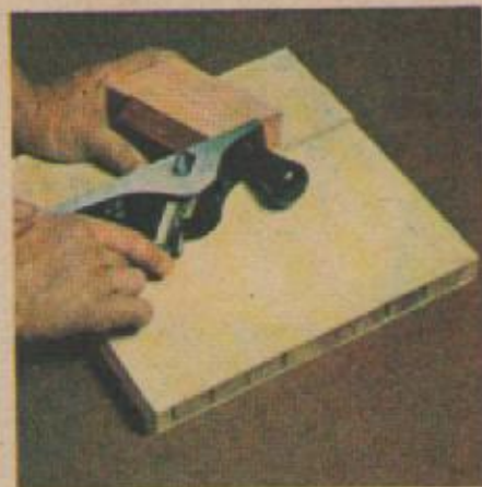
16. Сделайте фугочную доску с фанерным основанием и направляющими для обстругивания торцов деталей под углом 70^\circ . Обстругайте торцы до требуемого размера.
