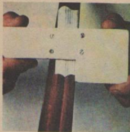
18. Для обработки остальной части багета переверните скребок. Во время работы прижимайте ручку скребка к краю багета.
