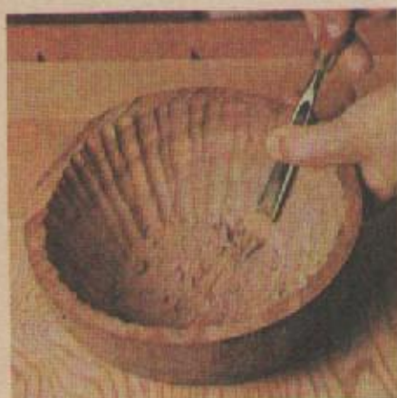
8. Снова закрепите вазу шурупом на фанерной основе и закончите обработку внутренней поверхности: ее можно сделать гладкой или оставить со следами полукруглой стамески.
