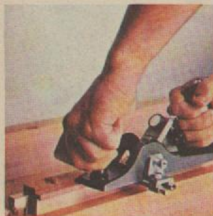
16. Фальц выбирается фальцгобелем с направляющей линейкой. Сделайте фальц шириной 10 и глубиной 6 мм.
