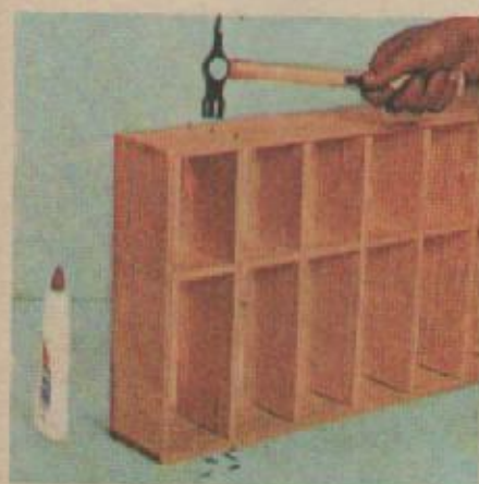
5. Прибейте боковые стенки. К каждой вертикальной перегородке прибейте верхнюю и нижнюю стенки.
