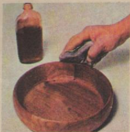
4. Изделия из некоторых пород древесины можно защитить пропиткой маслом. Несколько раз покройте изделие маслом, а затем отполируйте.
